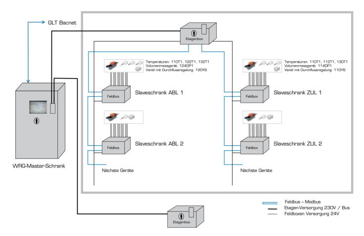
Die Anlagen werden über ein Mediumnetz miteinander gekoppelt (Kreislaufverbundsystem). Wie viele Anlagen in einen Verbund eingebunden werden, hängt von der Nutzung der Lüftungsanlage ab (z.B.: Seminarräume, Sporthalle, Gastronomiebereich). Was alle Auslegungen gemeinsam haben, ist eine eine zentrale Hydraulikstation je Verbund, welche das Medium von den Abluft- zu den Zuluftanlagen befördert.
